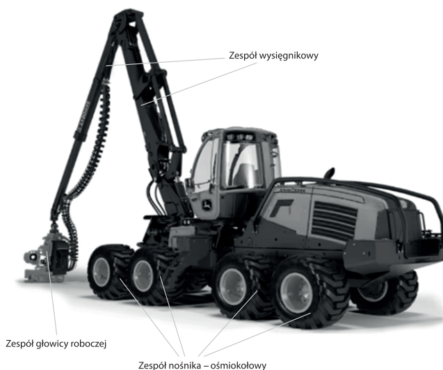
Rys. 1. Zespoły robocze harwestera
