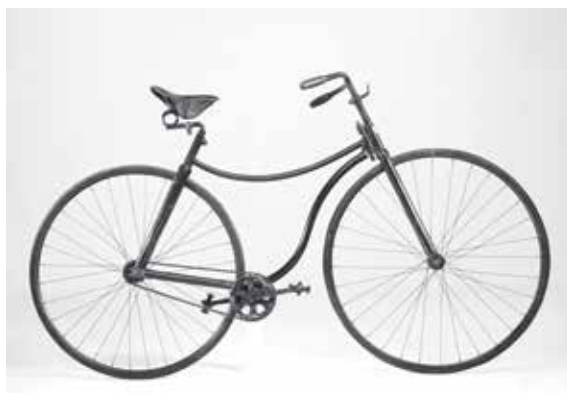
Rysunek 4. Rower z łańcuchowym mechanizmem napędzającym tylne koło
