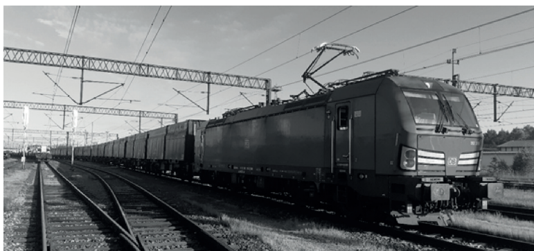
Rys. 12. Lokomotywa Siemens Vectron z wagonami Innofreight C45 Woodtainer XXL na stacji w Węglińcu
